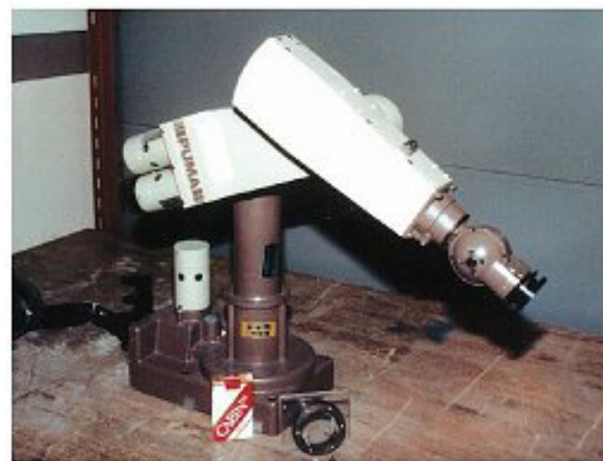
図1 産業用ロボットPUMA 260 川人先生が初めて実験に利用したロボット。腕だけのロボットだったが、小脳の運動学習の理論を示した。
